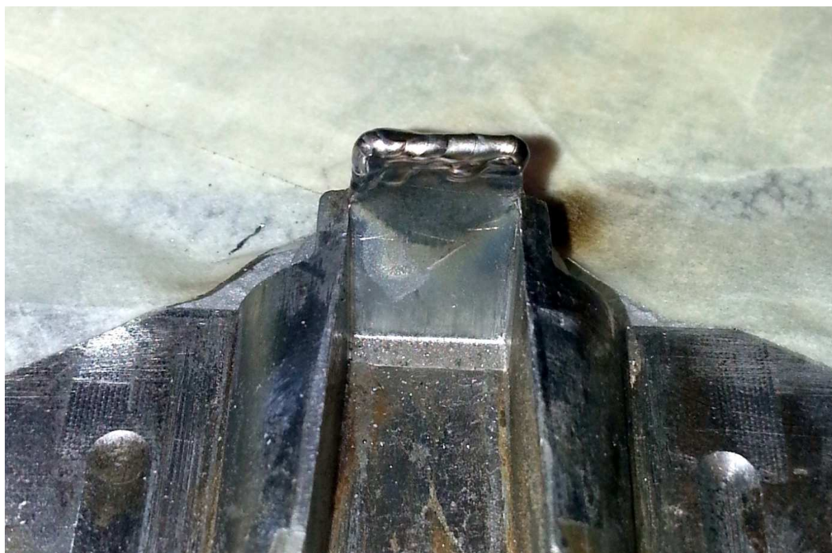
Naváření odlomené chybějící části formy materiál 1.2344 48 HRC.
