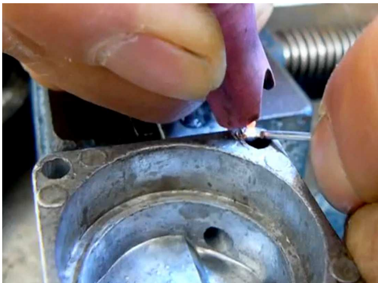
Zavařování otvoru u hliníkového odlitku.
