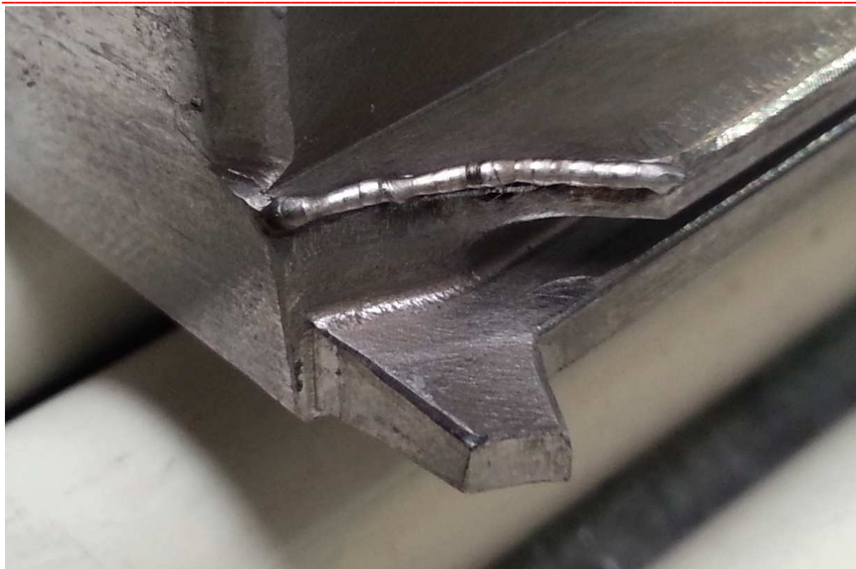
Navaření hrany u nerezového dílu před opracováním.
