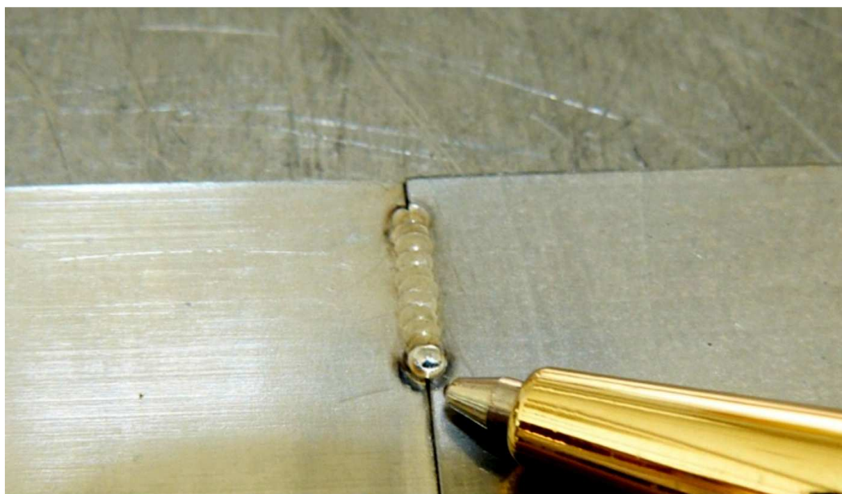
Postup svaření dvou plechů hranami k sobě bez přídavného materiálu.
