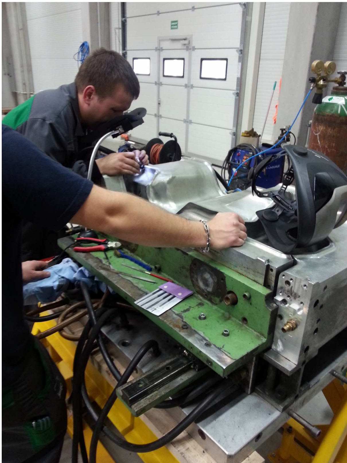
Oprava hrany na formě AL 7045 Certal.
