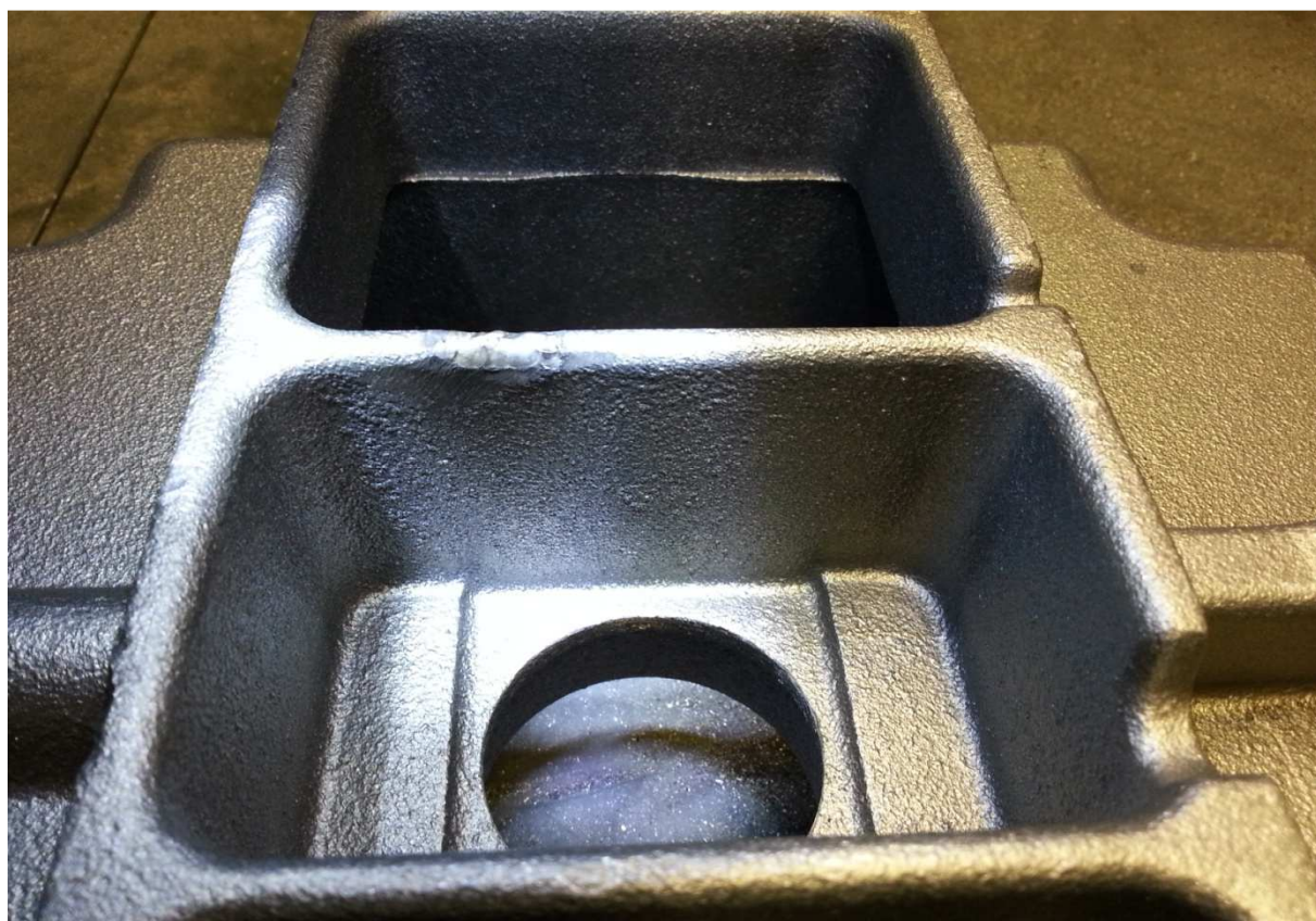
Oprava navařením u odlomené části u litinového odlitku.
