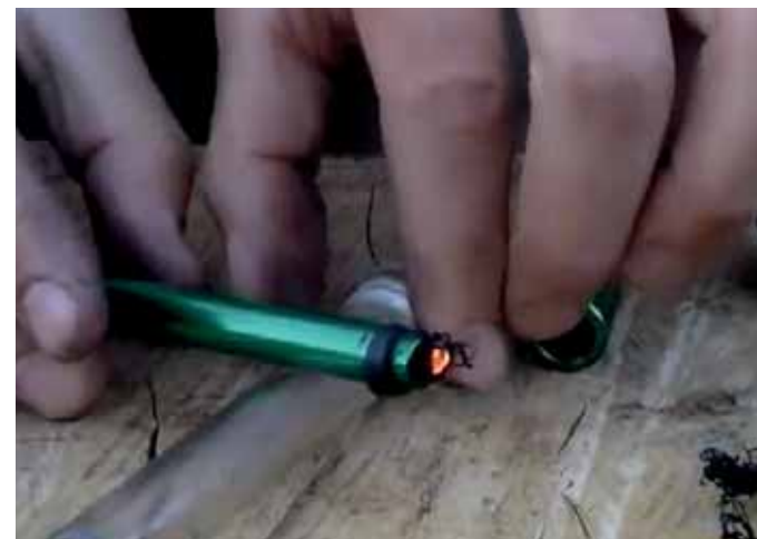
materiál hoří = viditelný diesel efekt
