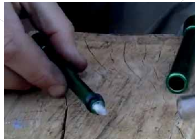
materiál nehoří = diesel efekt není pozorován. Přestože problém s odvzdušněním je přítomný (viz. obrázek zahoření na konci vstříkování vlevo).
